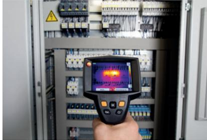
**Solución:** Mantenimiento eléctrico con cámara termográfica.
