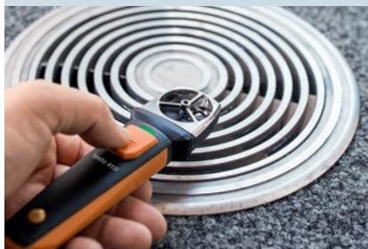
**Solución:** Medición y adaptación del caudal volumétrico en el canal y en la salida del canal.
