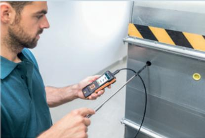
**Solución:** Medición de la velocidad de flujo y el caudal volumétrico en el canal de ventilación.
