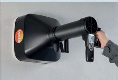
**Solución:** Medición de caudal precisa con rectificador.
