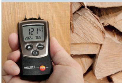
**Solución:** Medición rápida y sin daños de las humedades del material.
