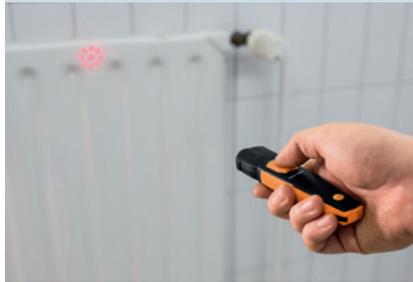
**Solución:** Medición de temperatura sin contacto.
