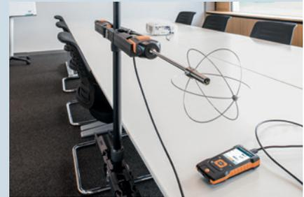
**Solución:** Evaluación completa de las condiciones climáticas con un analizador multifuncional. Evaluación conforme a las normas del confort según PMV/PPD. Cálculo de la calidad del aire interior.
