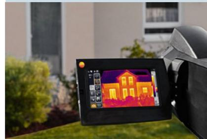
**Solución:** Determinar las pérdidas de energía mediante una termografía.
