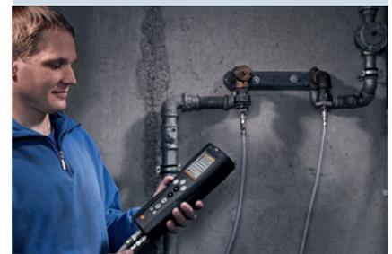
**Solución:** Prueba de estanqueidad con instrumento de medición certificado así como la documentación digital de los resultados como comprobante de peso.
