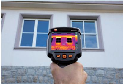
**Solución:** Visualización termográfica de todo el revestimiento del edificio con una cámara termográfica.
