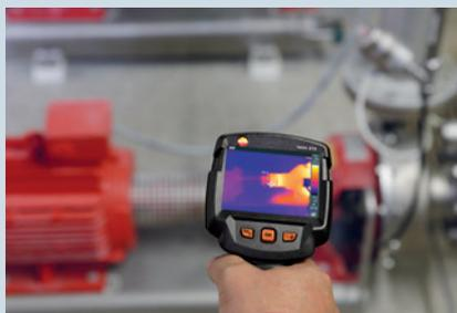
**Solución:** Detección temprana del desgaste a través del cálculo sin contacto del aumento de temperatura en componentes.
