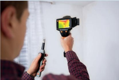
**Solución:** Visualización y localización de fugas, puntos húmedos y peligro de aparición de moho dependiendo del tipo de construcción.
