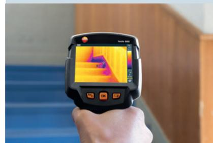
**Solución:** Medición de temperatura sin contacto.
