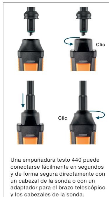
Una empuñadura testo 440 puede conectarse fácilmente en segundos y de forma segura directamente con un cabezal de la sonda o con un adaptador para el brazo telescópico y los cabezales de la sonda.
