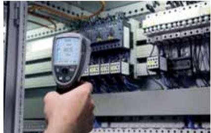
...para determinar la temperatura superficial de superficies rugosas (por ej. revoque, empapelados, etc.). Una medición con sondas es factible con limitaciones, debido al deficiente contacto térmico.
