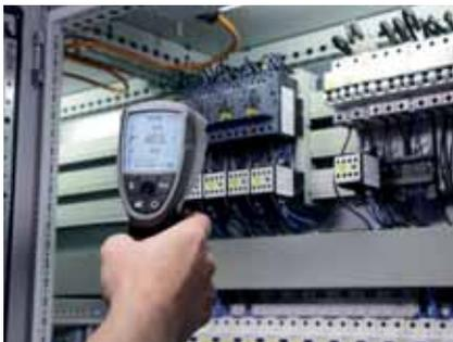
Localice temperaturas excesivas en armarios de distribución, medición en circuitos eléctricos, como por ej. resistencias, transistores en circuitos impresos, etc.
