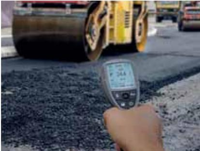
Medición rápida de la temperatura en obras viales.
