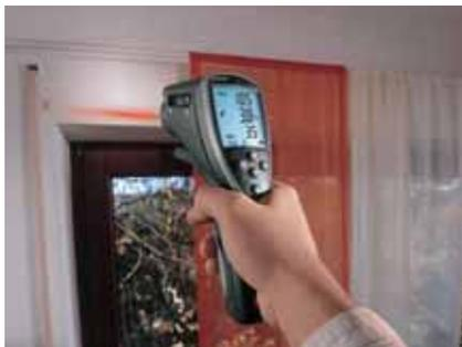
Control de gradientes térmicos o búsqueda de puntos críticos en edificios.
